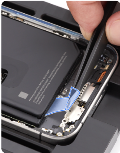
Les batteries de l'iPhone sont sécurisées à l'aide d'adhésifs avancés qui sont conçus pour se détacher lorsqu'ils sont étirés dans un sens donné, ce qui permet le remplacement de la batterie.
